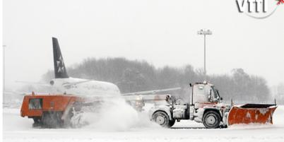
*Kehr- und Schneeblasgerät im Einsatz vor einem Airbus A320 der Austrian*
