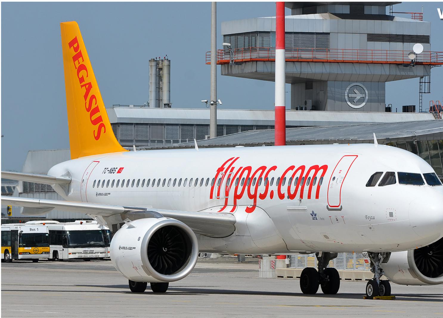
Mit Pegasus Airlines kommen nun auch Urlaubspassagiere in den Komfort eines Airbus A320Neo. Im Gegensatz zu den bisher nach Linz eingesetzten A320Neo der Lufthansa sind jene bei der türkischen Airline eingesetzte Exemplare mit LEAP-Triebwerken aus dem Hause CFM ausgestattet (Foto: M. David)
