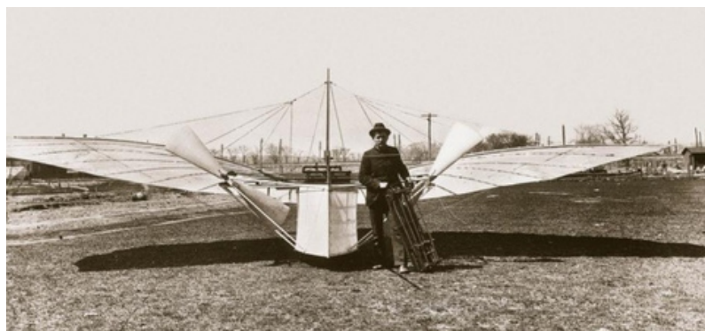
Gustave Whitehead neben seiner Flugmaschine "Nr. 21" im Frühjahr 1901. Der Flugapparat hatte eine Spannweite von 10,6 Meter. Seine in Nordamerika verwendete Schreibweise, war bei eingewanderten Nordamerikanern eine gängige Praxis.
