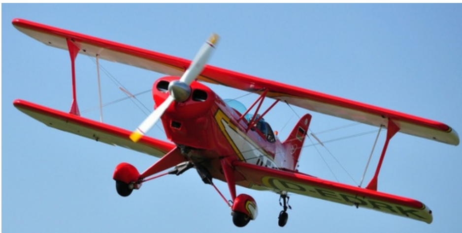
Am Bild gut erkennbar, dass der Slip, dem Piloten ermöglicht in Flugrichtung vorne links aus dem Cockpit zu sehen!
